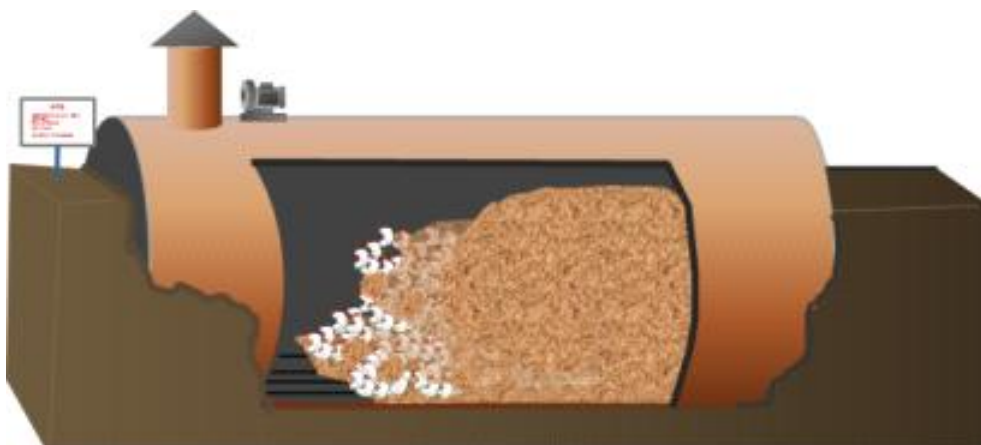
그림 15. 저장조를 이용한 호기성호열미생물 가축 매몰처리 개요도
