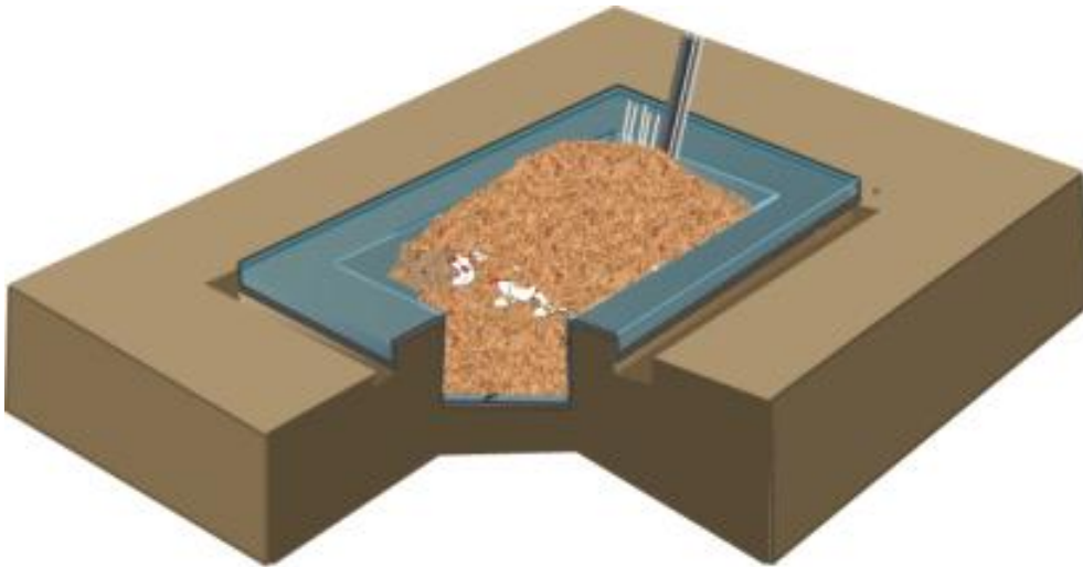
그림 13. 호기성호열미생물을 이용한 소취용 봉분층 만들기 개요도
